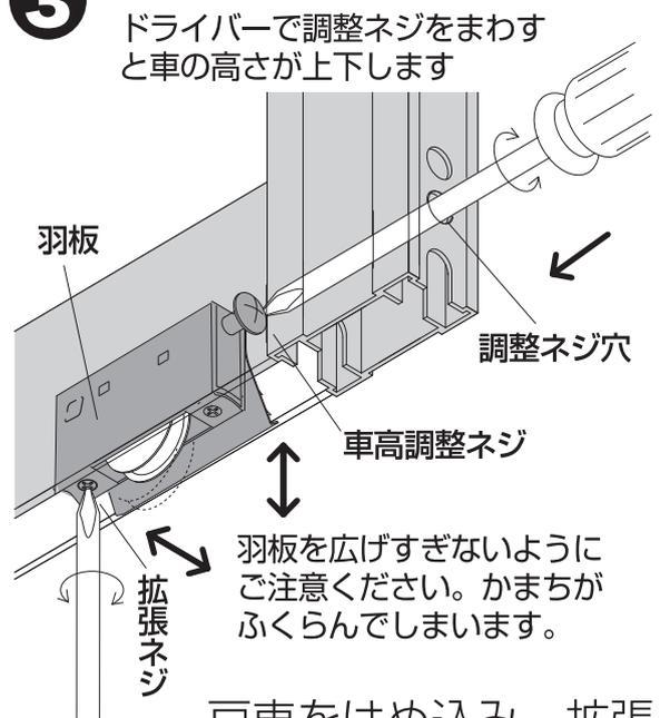
ドライバーで調整ネジをまわすと車の高さが上下します
