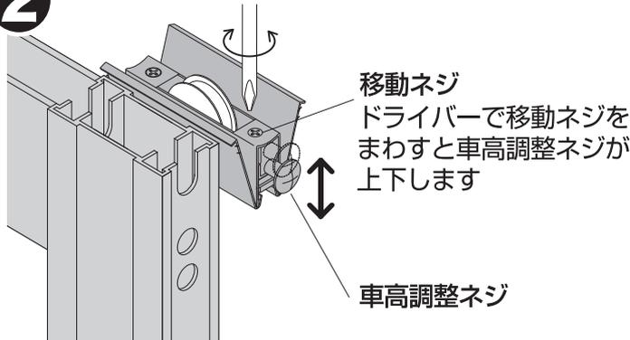
調整穴の位置が**有効範囲内27~37の場合**は戸車の移動ネジで車高調整ネジを引戸の穴位置に合わせます。(2図参照)
