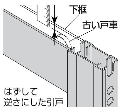
2. はずした引戸を逆さにし、下框下端部から古い戸車までの距離を測ってから古い戸車ははずしてください。
