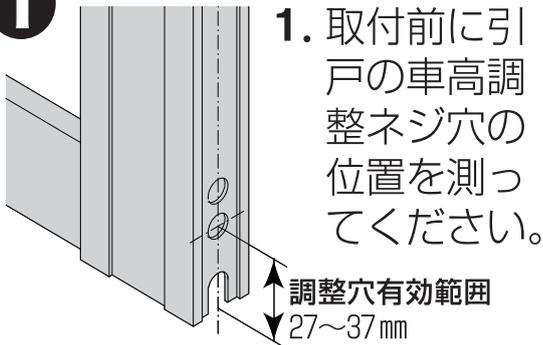
1. 取付前に引戸の車高調整ネジ穴の位置を測ってください。
