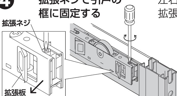
左右の拡張ネジをドライバーでまわし、拡張板を拡げて框に固定させます。
