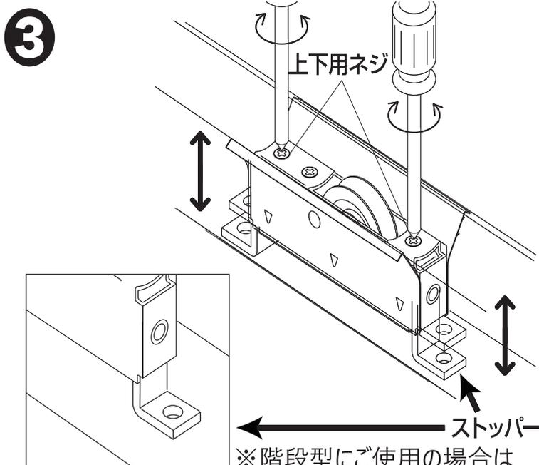
3 上下用ネジをまわすと車の高さが上下します。ドライバーで上下用ネジをまわすと車の高さが上下します。ストッパーが下かまちの底に届くまで上下用ネジをまわしてください。
