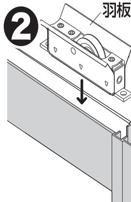
2 古い戸車をはずし、図のように新しい戸車を下框に差し込んでください。階段型にご使用になる場合は羽根を外してから、取付けてください。
