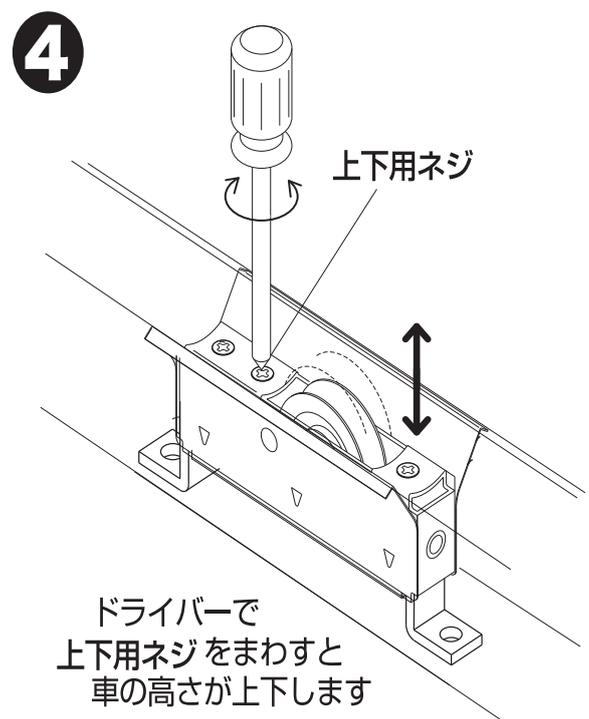
4 ドライバーで上下用ネジをまわすと車の高さが上下します。ドライバーで上下用ネジをまわすと車の高さが上下します。上下用ネジをドライバーでまわし1で測った距離に合わせて調整をしてください。
